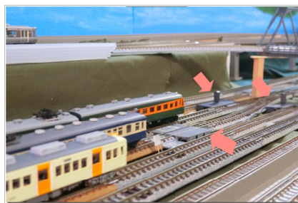
モード5では3カ所のセンサーにより3列車が順番に台上の終点まで往復する
