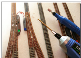
ドライバーとリユーターで穴開け
